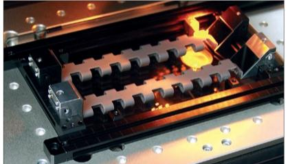
Das DF-System ist ein universell einsetzbares Spannsystem und kann auf jeder Messmaschine montiert werden. Mit speziellen Adaptern ist das System mit dem Messtisch der DeMeet Video- und Multi-Sensor-Koordinatenmessmaschine vollständig kompatibel.
