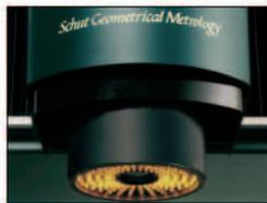
Beleuchtung ist die Voraussetzung für genaue Messungen. Die DeMeet ist mit LED-Beleuchtung ausgestattet (Durchlicht, Koaxialbeleuchtung und Segment-Ringbeleuchtung).
