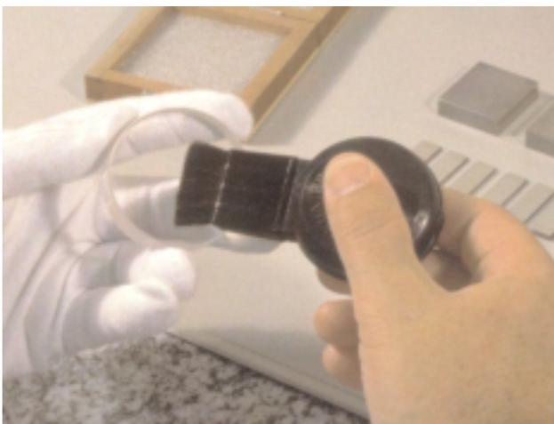
Bild 38 Abblasen der letzten Staubpartikel an den Messflächen durch einen Pinsel mit integriertem Gummibalg
