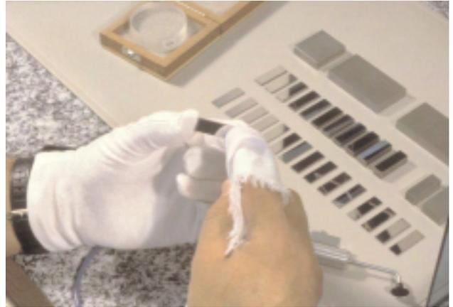
Bild 37 Abschließendes Reinigen und Polieren der Endmaßmessflächen mit einem Leinen- oder Microfaser-Tuch
