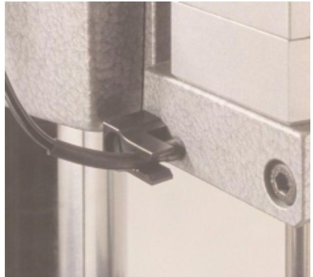
Bild 76 Montierter Temperaturlaufnehmer, das Kabel ist zur Zugentlastung und zur sicheren Positionierung des Messwiderstandes an der Klemmbrücke befestigt
