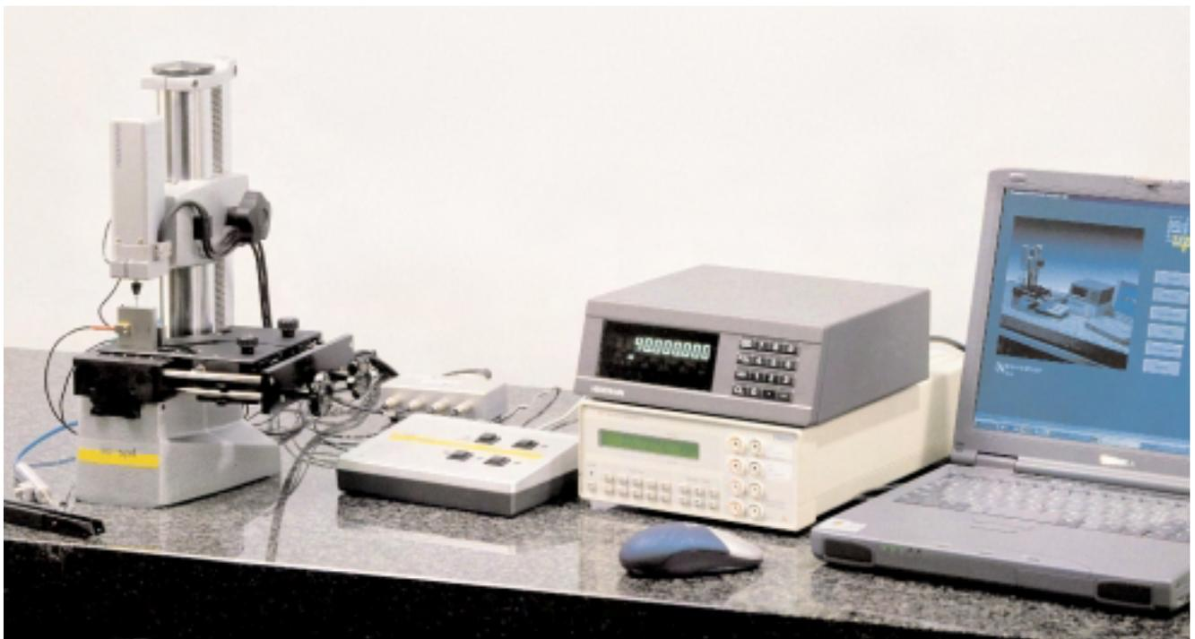
Bild 1 TESA Endmaßmessgerät *upd* komplett mit TESA Temperaturmesseinrichtung *upt*
