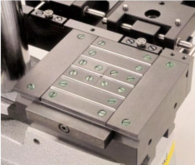
Bild 78 Messtisch mit montierten Hartmetall-Zylinderstiften
