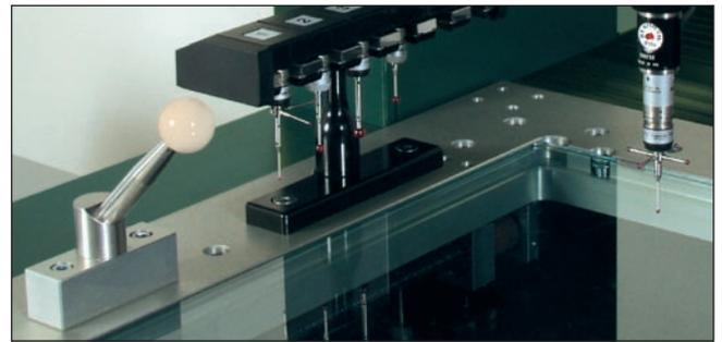
Videoschablonen, die größer als das Gesichtsfeld sind, können in einem Programmschritt gemessen werden, und werden automatisch in mehrere Bilder aufgeteilt und für das fitted Ergebnis wieder zusammengefügt. Die Korrektur des Kamerawinkels macht die Kombination von einzelnen, erfassten Videobildern sehr genau. Die Beleuchtung für die Videomessung kann über eine grafische Steuerung für Durchlicht, Koaxiallicht, sowie das Ringlicht eingestellt und verändert werden.
